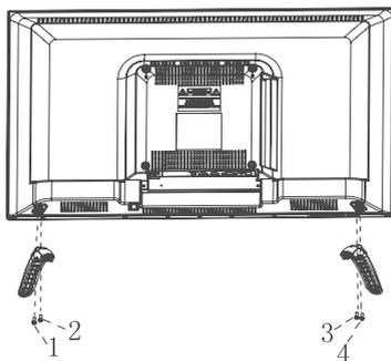
2. Для крепления подставки положите дисплей передней панелью на горизонтальную поверхность, например, стол, предварительно накрытый мягкой тканью.
