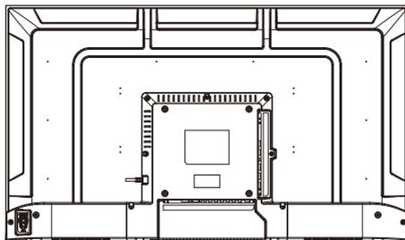
3. *Установите 2 резиновые прокладки в отверстия винтовых креплений в нижней части задней панели телевизора.*
